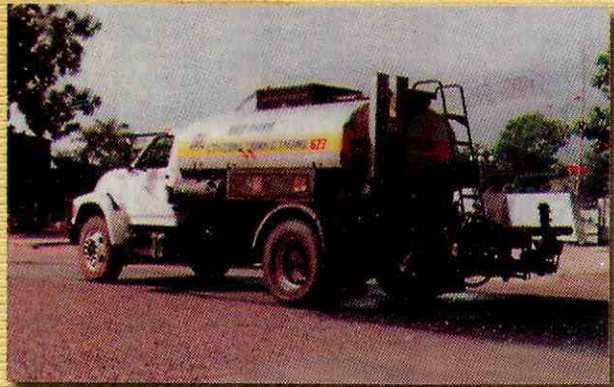
Xe tưới nhựa trước khi thảm bê tông QL1 Máy tưới nhựa hiện đại tự động
